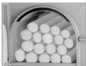
Formato il letto di braci si può procedere alla carica della legna. Aprire lentamente la porta del magazzino legna, per dare modo al ventilatore di aspirare i fumi accumulati nel magazzino legna. Per mezzo dell'attizzatoio in dotazione, aprire lentamente la porta e distribuire uniformemente le braci sulla griglia principale. Si potrà poi procedere alla carica della legna, che dovrà essere effettuata con tronchetti della stessa lunghezza del focolare.
