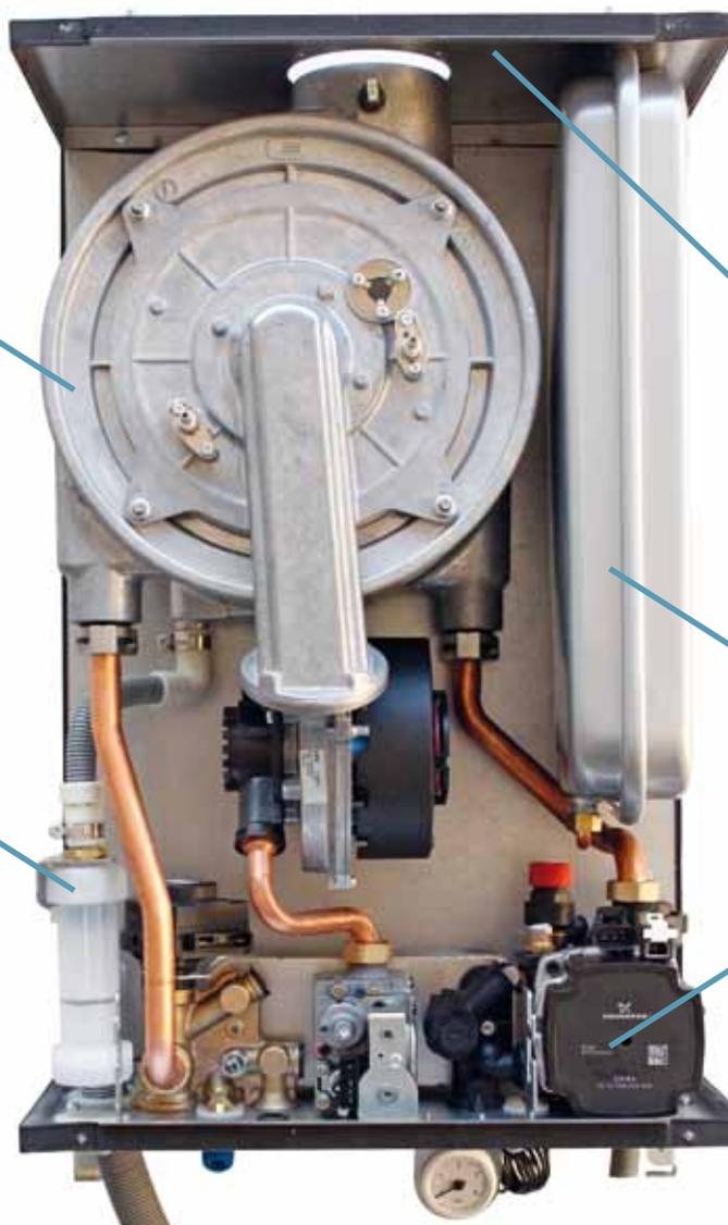
Nella parte superiore della caldaia è posizionata la valvola per il carico del vaso di espansione, che consente la verifica e la ricarica della pressione del vaso stesso senza dover aprire la caldaia.
