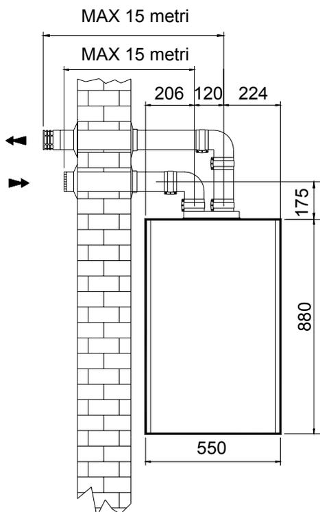
N.B.: La somma della lunghezza del tubo di scarico e quella del tubo di aspirazione non deve superare i 30 metri.
