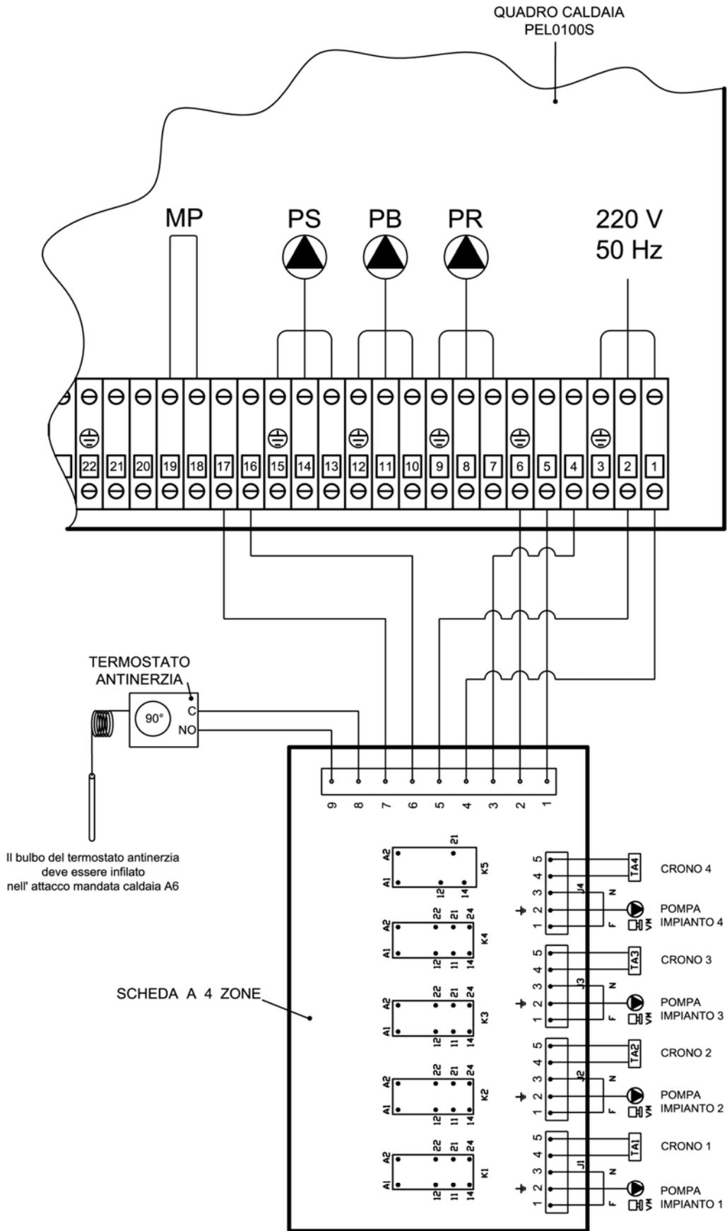
Il bulbo del termostato antinerzia deve essere infilato nell' attacco mandata caldaia A6
