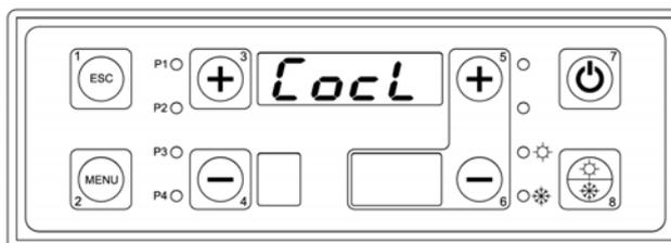
\* Il parametro **COCL** è da testare solo se è previsto il suo utilizzo ovvero su caldaie tipo **DUO TECH** o **GRANOLA AUTOMATICA / MANUALE**.
