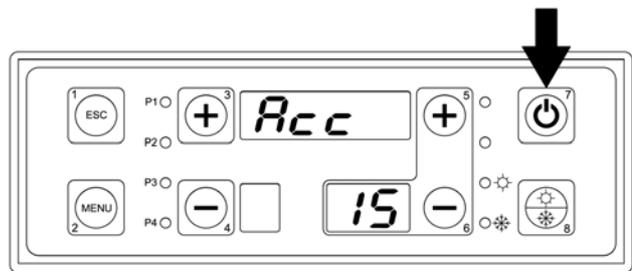
Nel momento in cui viene avviato il ciclo di funzionamento sul display superiore compare la scritta "ACC" indicante la fase di accensione caldaia. Questa scritta rimarrà sul display finchè la temperatura dei fumi non supera la *minima temperatura fumi in accensione* (tarata a 70°) nel tempo impostato dal parametro *tempo fase di accensione* (tarato a 30 minuti) ; in questo stato il ventilatore funziona alla massima velocità.
