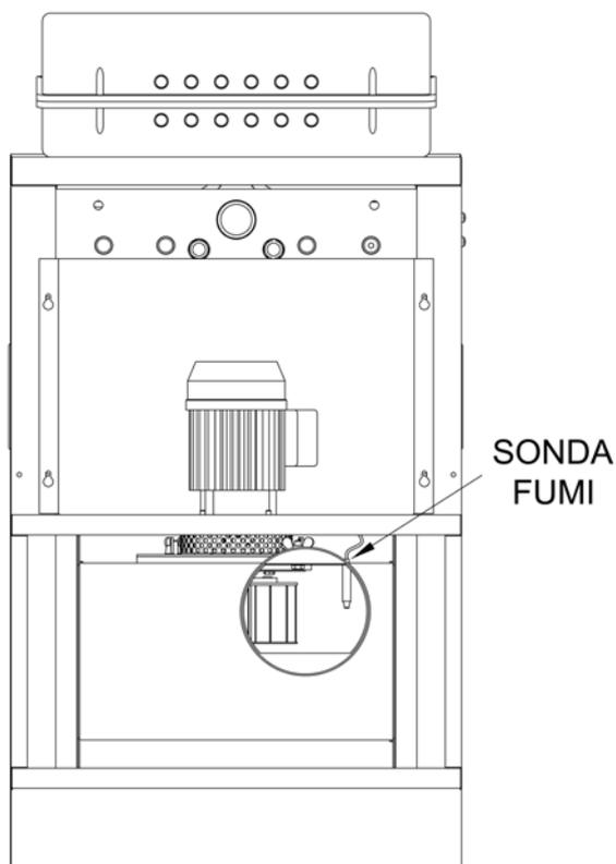
La sonda fumi è già cablata sulla scheda elettronica ai morsetti 31,32 come in figura a pag. 16.
