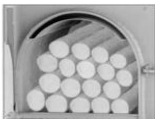
Formato il letto di braci si può procedere alla carica della legna. Aprire lentamente la porta del magazzino legna, per dare modo al ventilatore di aspirare i fumi accumulati nel magazzino legna. Per mezzo dell'attizzatoio in dotazione, aprire lentamente la portina antifumo e distribuire uniformemente le braci sulla pietra principale. Si potrà poi procedere alla carica della legna, che dovrà essere effettuata con tronchetti della stessa lunghezza del focolare.
