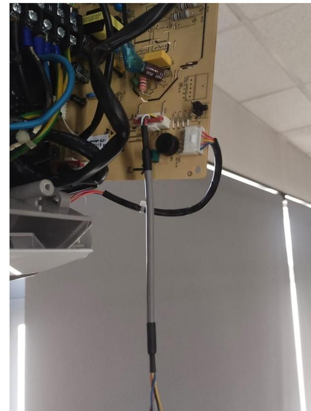
Nel caso il cavetto di connessione non fosse visibile, potrebbe essere nascosto tra i vari cablaggi della scheda elettronica. Dalle fotografie è possibile notare il cavetto e l'ubicazione del suo innesto sulla scheda elettronica. Istruzioni, e app scaricabili utilizzando codici QR presenti all'ultima pagina del libretto uso del climatizzatore
