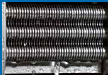
Scambiatore inox in fase di condensazione
