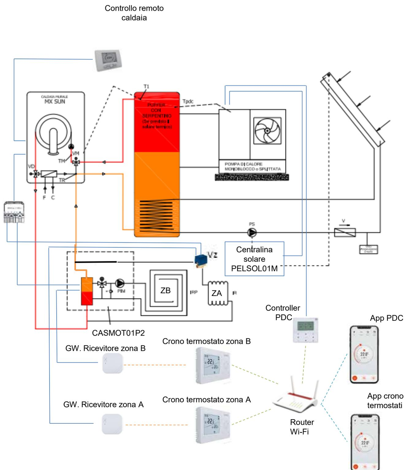
Schema elettrico caldaia SUN-PDC-Distribuzione impianto «Smart»
