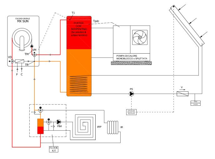
La logica di questo schema è che la caldaia murale a gas è utilizzata solo come soccorritore di ultima istanza, il solare, o la PdC hanno la priorità.
